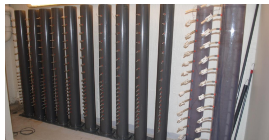
Kolonnförsök med sediment i behållare vid botten och havsvatten påfyllt i hela röret. Vattenprov kan tas ut på olika nivåer.
